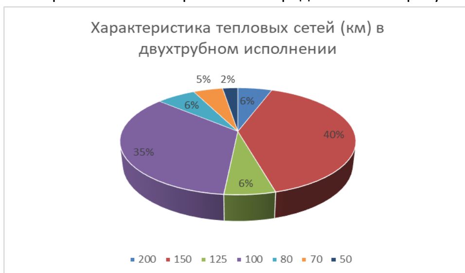
Рисунок 1.2 – Распределение протяженности тепловых сетей муниципального образования пос. Уршельский по диаметрам труб в 2019 году (км.)
